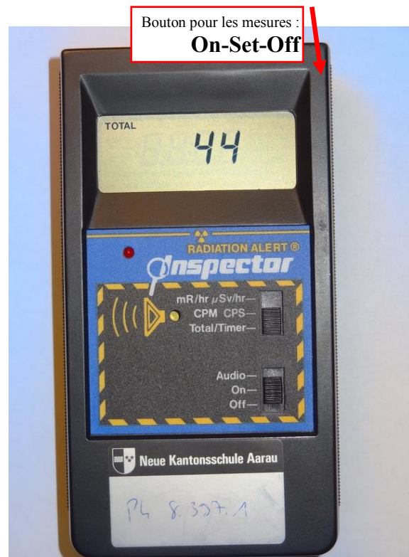
Figure 2 : compteur Geiger-Müller « Inspector »
